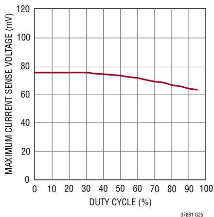
最大電流検出スレッシュホールドとデューティ・サイクル
